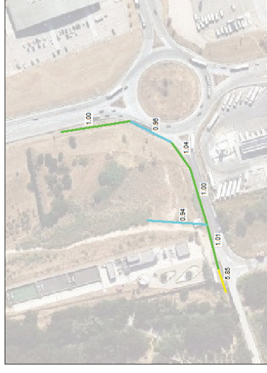
Figura 11. Traçat de les conduccions considerades en la modelització de l'estat actual del sector. El nombre que acompanya els conductes indica la pendent de fons en tant per cent (%).
