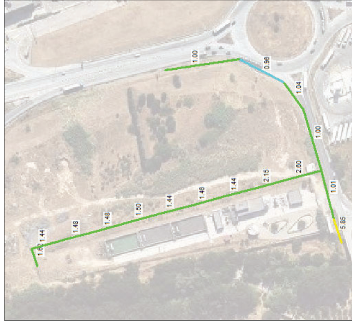
Figura 20. Vista en planta de les conduccions considerades per modelitzar el sistema de drenatge del sector desenvolupat. El nombre que acompanya els elements indica la pendent de fons dels tubs en tant per cent (%).
