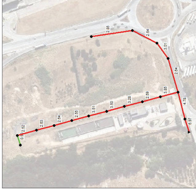
Figura 24. Vista en planta de l'eix de drenatge. El nombre que acompanya les conduccions indica la velocitat assolida per l'aigua en l'instant més crític de l'episodi modelitzat.
